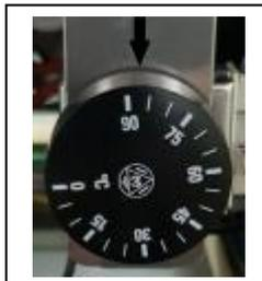
Os termostatos estão predefinidos nas seguintes temperaturas: 55°C para a água de lavagem (cuba) e 85°C para o enxaguamento (caldeira). O termostato da cuba não pode ser regulado, mas é possível regular o da caldeira com o manipulo do próprio termostato, ou a partir do painel de comandos, nas versões com painel de comandos eletrônico.
