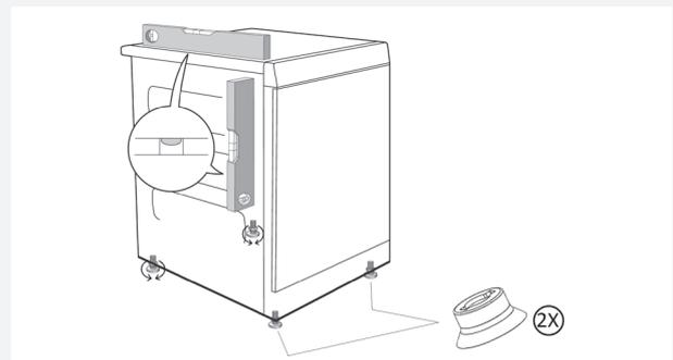
5. Schrauben Sie die Gerätefüße so weit heraus oder hinein, bis der Wäschetrockner vollständig in der Waagrechten ausgerichtet ist, egal, ob er auf dem Boden oder auf der Waschmaschine aufgestellt wird.
