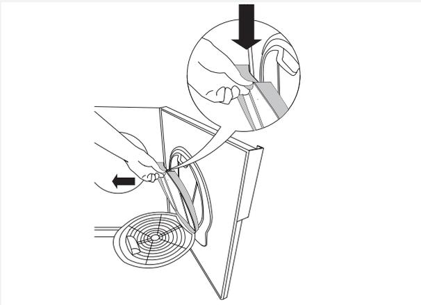
3. Entfernen Sie die angesammelten Fusel mit der Hand oder einem weichen Tuch. Verwenden Sie bei Bedarf einen feuchten Schwamm mit etwas Geschirrspülmittel, um hartnäckige Faserreste zu entfernen. Trocknen Sie danach das Flusensieb gründlich mit einem trockenen Tuch.
