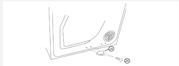
4. Stecken Sie die Gummisauger auf die vorderen Gerätefüße des Wäschetrockners.
