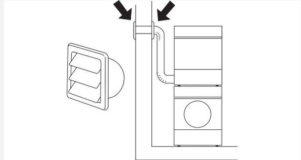
Wenn es nur eine Abzugsleitung aus dem Raum gibt, muss die Abzugssicherung angebracht werden.
