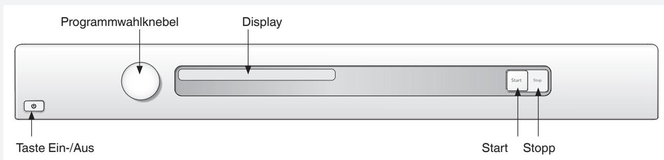
Wählen Sie durch Drehen des Programmwahlknebels das entsprechende Programm aus.
