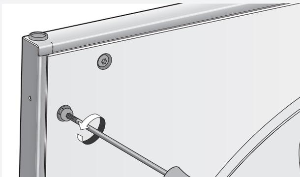
6. Lösen Sie den inneren unteren Teil der Luke (nach unten ziehen und anheben).
