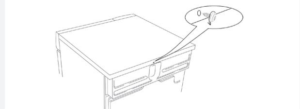
2. Sichern Sie den Kippschutz mit den beiden Schrauben, wie auf dem Bild gezeigt.
