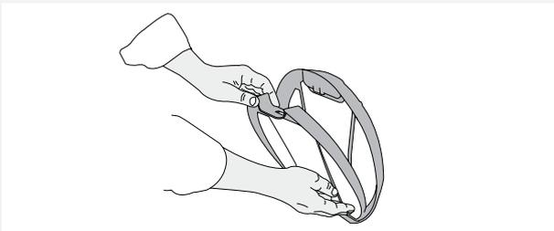
4. Schließen Sie das Flusensieb, setzen sie es in die Halterung ein und klappen Sie diese zu.
