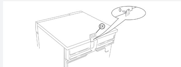
3. Nehmen Sie das zweite Befestigungsstück und zwei Schrauben aus der Schachtel. Montieren Sie das zweite Befestigungsstück mit zwei Schrauben an den Wäschetrockner.
