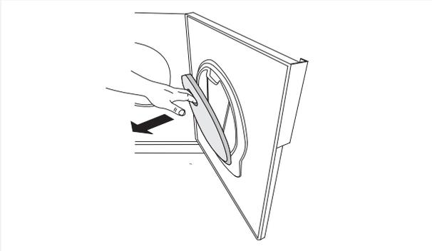
2. Öffnen Sie das Flusenfilter, indem Sie mit dem Daumen auf den Rand drücken (siehe Abb.) und ziehen Sie es heraus.
