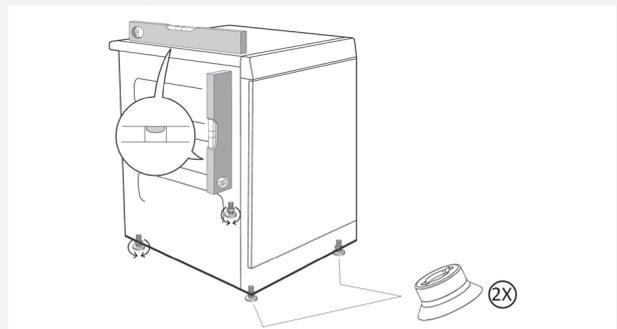
5. Avvitare o svitare i due piedini anteriori dell'apparecchio fino a quando l'apparecchio non è completamente dritto orizzontalmente sia a terra che sulla lavatrice.
