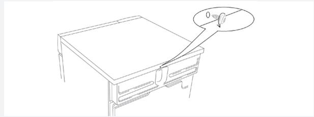
2. Fissare il dispositivo antiribaltamento con le viti, come mostrato nella figura.
