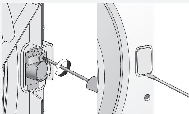
8. Rimontare la parte interna dello sportello e fissatelo con le viti (sono 13).
