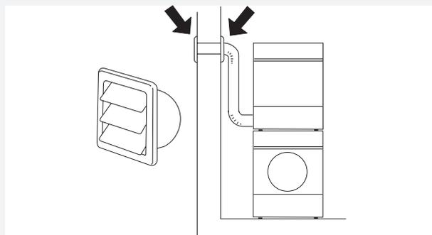
Se nell'ambiente vi è una sola apertura di ventilazione, è necessario installare un dispositivo per regolare la corrente d'aria.
