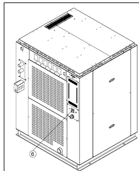
L'interruttore generale, quando in posizione "1", alimenta elettricamente la macchina.
