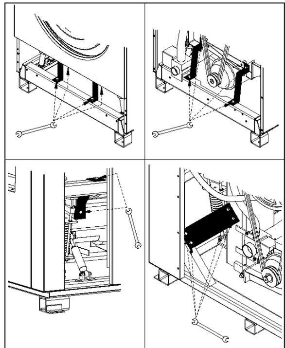
Tutti i pannelli devono essere rimontati nella posizione originale, prima di poter avviare la macchina. Dopo averli rimossi, i fermi devono essere conservati e riutilizzati ogniqualvolta la macchina debba essere trasportata. I fermi di trasporto non sono presenti nelle macchine lavacentrifughe rigide.
