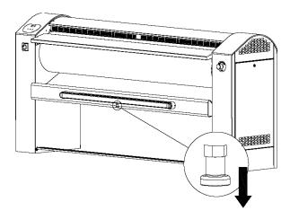
Quando l'emergenza è risolta, per sbloccare la barra antipanico, tirare il perno a molla verso il basso, e tenerlo tirato, fino a che la barra antipanico ritorna nella sua normale posizione di riposo (si veda figura).
